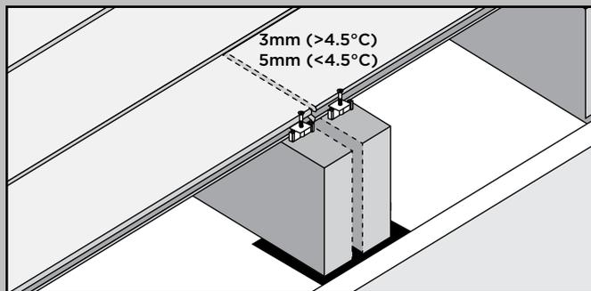
**HINWEIS:** Abstände des Unterkonstruktions-Doppelriegel 3 mm bis 6 mm, um das Abfließen von Wasser zu ermöglichen.
