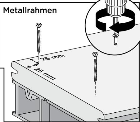
Bei Holzkonstruktionen können Sie eine Dielenfuge mit einer leicht schräg gesetzten Schraube fixieren. Bohren Sie entsprechend vor und halten Sie einen 25 mm Abstand vom Dielenende.
