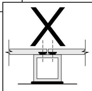
Sicherstellen, dass die Unterkonstruktion ordnungsgemäß befestigt ist.
