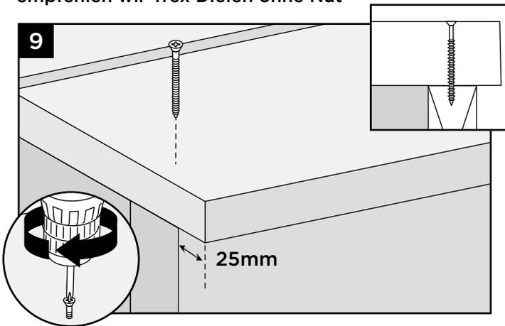
Randabschluss: Trex Dielen ohne Nut müssen auf der Innenseite mit Nuten versehen werden um sie mit den Trex Universalbefestigern zu befestigen. (Siehe Seite 19)
