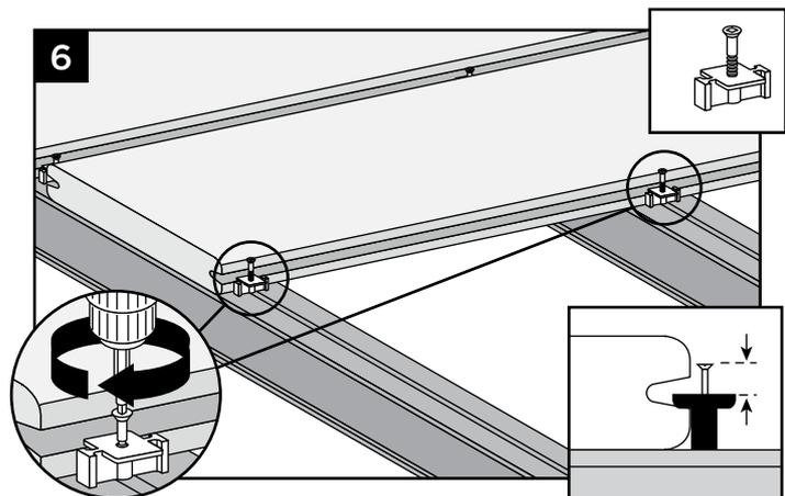
**TIPP:** Verwenden Sie beim fixieren der Trex Universalbefestiger ein etwa 60 cm langes Dielenstück zum andrücken von gleichzeitig zwei Befestigern. Diese Hilfe erleichtert die korrekte Montage der Universalbefestiger.
