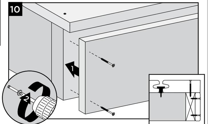
Die senkrechten Abschlussblenden können mit farblich passenden Schrauben montiert werden. Fragen Sie im Handel nach diesem Zubehör.
