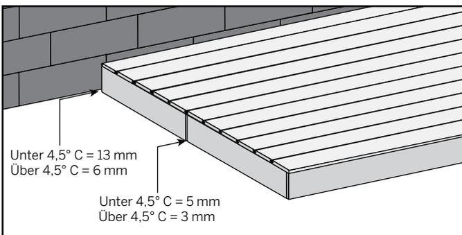
Bei Verwendung von zugelassenen Schraubabständen bei Verwendung der von Trex freigegebenen Schrauben:
