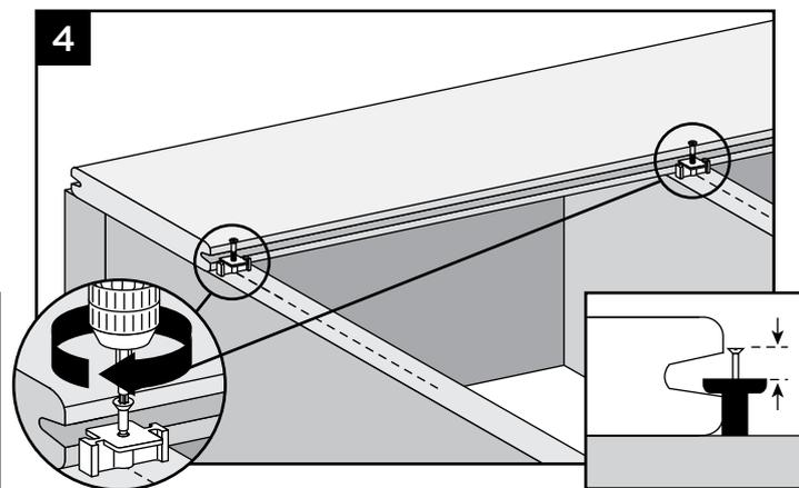
**TIPP:** Verwenden Sie beim fixieren der Trex Universalbefestiger ein etwa 60 cm langes Dielenstück zum andrücken von gleichzeitig zwei Befestigern. Diese Hilfe erleichtert die korrekte Montage der
