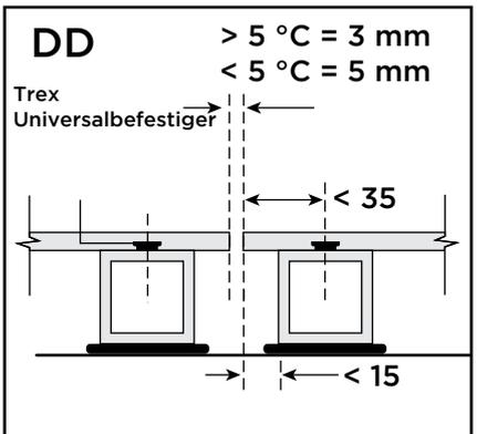
Sicherstellen, dass die Unterkonstruktion ordnungsgemäß befestigt ist.
