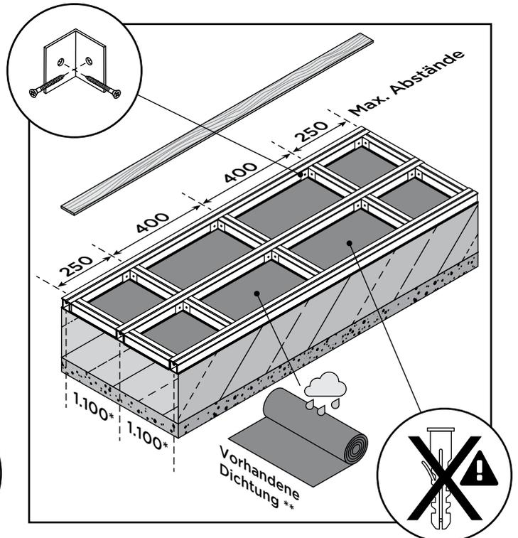
\* Die Abstände der Längsaussteifung bei Rahmenkonstruktionen sind abhängig von den Materialstärken des Lieferanten.
