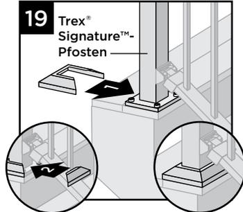
19. Befestigen Sie bei Trex Signature-Pfosten die mitgelieferte Sockelverkleidung unten an den Pfosten.
